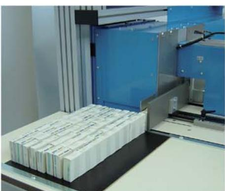
Die Bedienung ist denkbar einfach: der Benutzer muss nur die Anzahl der Stapel und Banderolierungen eingeben, dann übernimmt die Servosteuerung den sorgfältigen Einschub und die Auslösung der Banderolierung.
