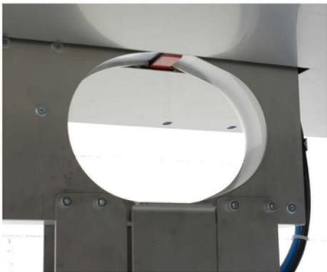
Der Rundbogen ist speziell auf die Produktgröße angepasst um eine hohe Taktfrequenz zu ermöglichen. Die Maschine erreicht bis zu 50 Bänderolierungen/Min. und ist auf 24/7-Dauerbetrieb ausgelegt. Sie ist auch mit Standardbogen lieferbar.
