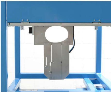
Die kompakte Bauweise der Maschine ist ideal für den Inline-Einsatz. Dank der Überkopfmontage ist das Bänderolieraggregat vor Schmutz geschützt und der Verschluss der Bänderole kommt auf der Oberseite des Produkts zu liegen. Der Hebepusher fixiert das Produkt für die Bänderolierung.
