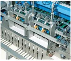
Durch den Zwischenstapler wird ein kontinuierlicher Betrieb der Falzmaschine gewährleistet. Es können jegliche Formate von A6 bis A4 (oder Breite 90 x Länge 110 mm bis Breite 330 x Länge 560 mm) verarbeitet werden.
