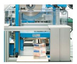
Je nach Produkt sind Geschwindigkeiten bis 200 M/Min. verarbeitbar. Pro Minute sind bis zu 30 Banderolierungen möglich. Die Anlage kann mit oder ohne Banderolierung arbeiten.
