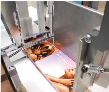
Produkte werden via Förderband in die US-2000 TRS-L3 transportiert wo der Stapel allseitig zentriert, gepresst und 1- oder 2-fach banderoliert wird.
