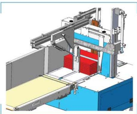
Das 3-fach Förderband ermöglicht die direkte Abnahme vom Kreuzleger ohne Auslaufband und schafft Stauraum für einen Produktstapel. Die Seitenführungen werden mittels Massstab auf die Produktbreite eingestellt.
