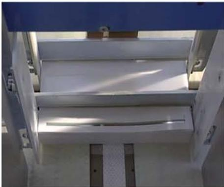
Stabile, ausgerichtete Produkte werden via Förderband in die US-2000 TRC gefördert. Die Stapel werden seitlich ausgerichtet und 1- oder 2-fach banderoliert.
