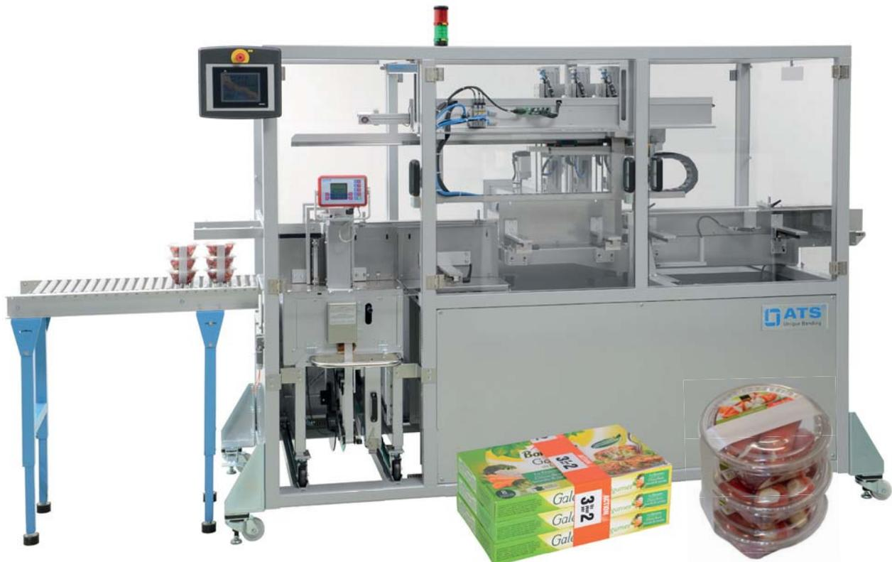
Die automatische Banderolieranlage US-2000 SIB-L übernimmt die Produkte mittels Einlaufförderband direkt von der Produktionsanlage. Der Mehrfach-Abstapler ermöglicht eine fließende Produktion, wobei die Produkte nach dem Stapeln mittels Servo-Achse in die Banderoliermaschine zugeführt werden. Anschliessend erfolgt die Banderolierung und das Ausstossen durch den nachfolgenden Stapel, gleichzeitig werden die nächsten Stapel gebildet.
