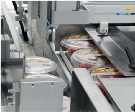
Der Mehrfach-Abstapler ermöglicht eine fließende, unterbrechungsfreie Produktion. Je nach Produkt und Zuführung können bis zu 120 Produkte/Min. verarbeitet und dabei bis zu 30 Stapel banderoliert werden.
