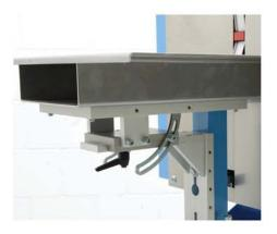
Durch den leicht verstellbaren Schrägtisch wird die genaue Positionierung des Produktes erleichtert. Je nach Produkt sind unterschiedliche Schrägtische lieferbar.
