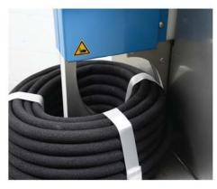
Nach dem Banderolieren wird der Schieber wieder geöffnet.
