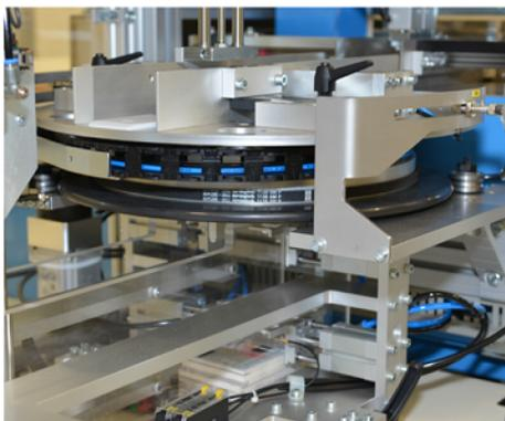
In der servogetriebenen Drehstation wird jeder zweite 100er Bund 180° gedreht, damit der Stapel mit zehn Bündel flach bleibt.
