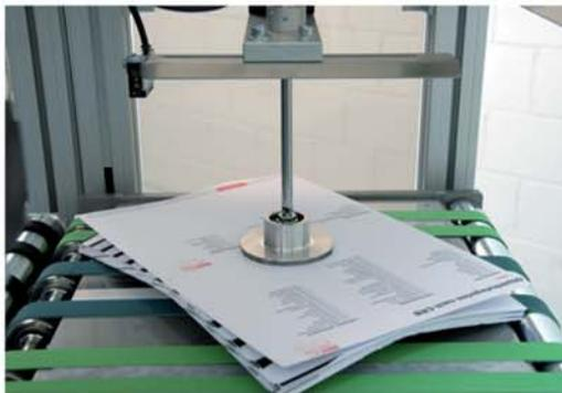
Der A4-Stapel wird auf der Wendestation gedreht und dem Handling-System zugeführt.
